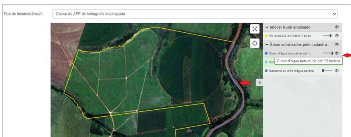
Figura 40. Classe de APP hidrografia inadequada. Nesse caso, o proprietário/possuidor declarou um curso d'água de até 10 metros, sendo que o correto seria a classe de 10 a 50 metros
